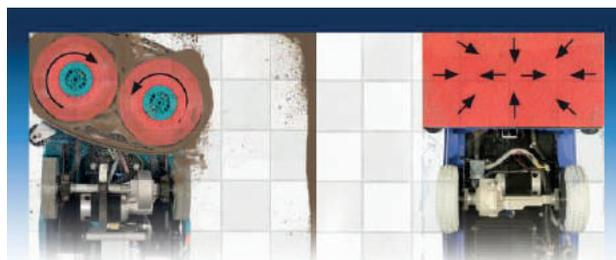
Nettoyage unidirectionnel des machines conventionnelles à disques
